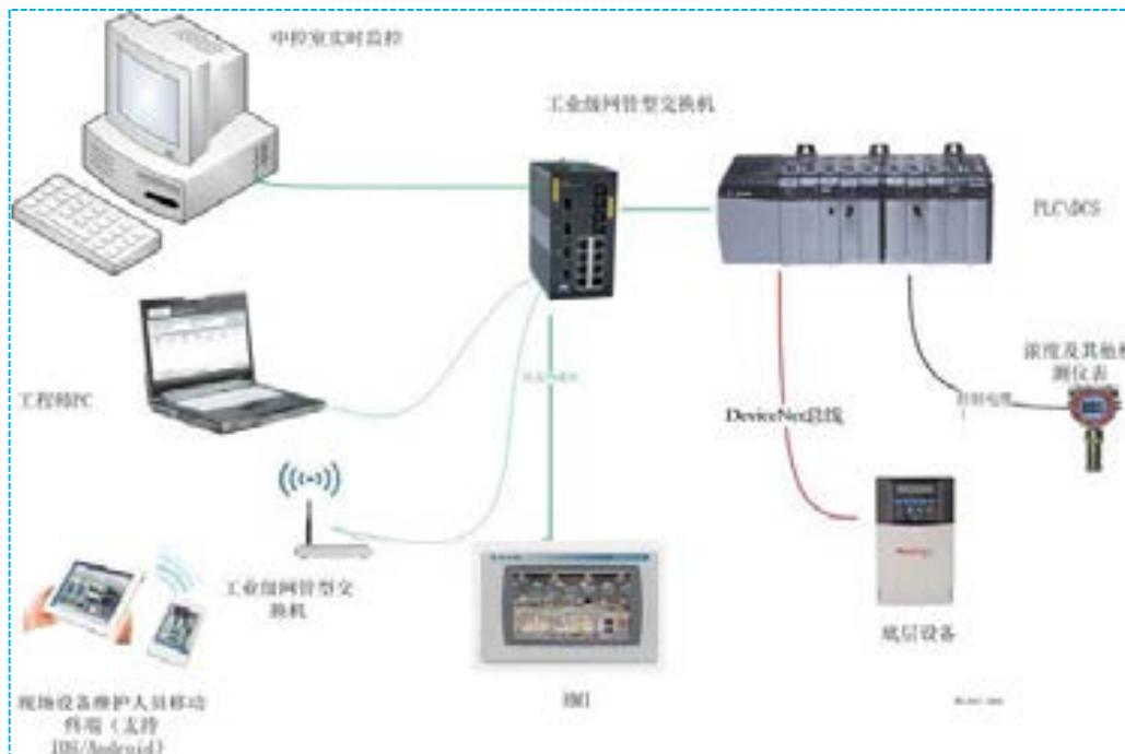
图 6.2-19 PLC 自控系统图
